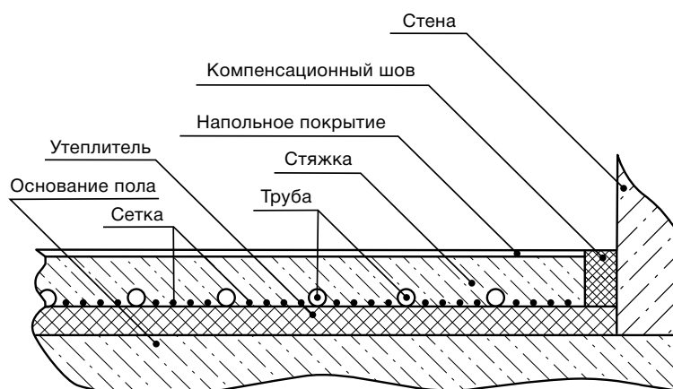
Рисунок 23. Схема устройства системы «Теплый пол»
